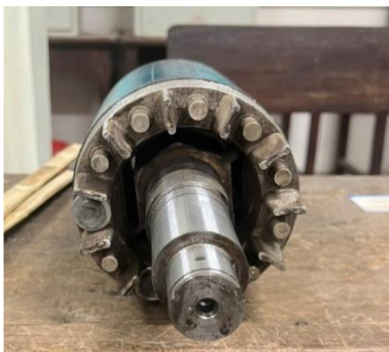
Hình 4.1. Kết cấu rôto sau khi chế tạo
