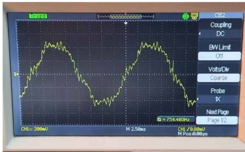
Hình 4.3. Đặc tính dòng điện của Ex-LSPMSM trên máy hiện sóng
