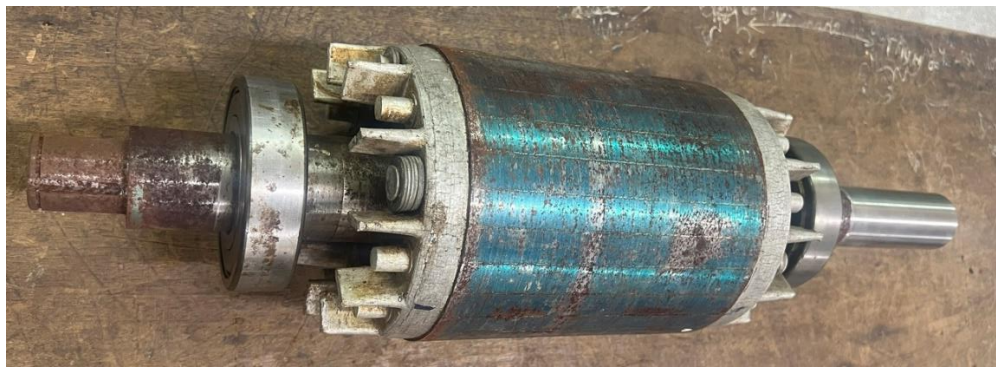
Hình 1.5. Phần động của động cơ Ex-LSPMSM [14]
