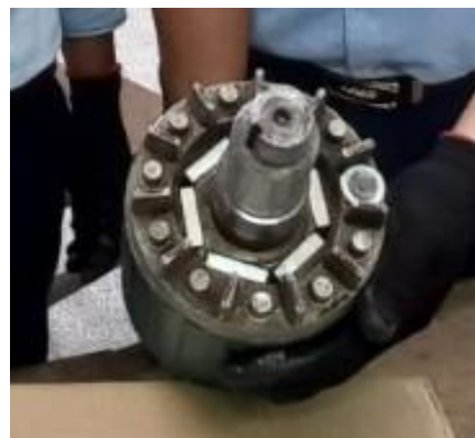
Hình 4.1. Kết cấu rôto sau khi chế tạo
